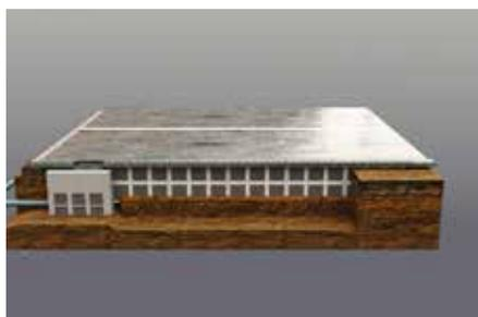
Une construction routière innovante en combinaison avec des éléments spéciaux en béton préfabriqué permet à la Slijperstraat à Staden de fonctionner comme un champ non cultivé tout en étant aussi durable qu'une route classique, même avec un trafic intense !
